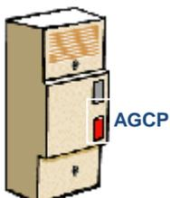
Les disjoncteurs de branchement (AGCP) sont installés dans chaque local à alimenter. Pour les branchements à puissance limitée, il sera sur le même tableau que le compteur. Ils sont impérativement placés dans les locaux privatifs du client (locaux réservés à l'usage exclusif du client).
